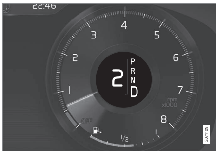
Førerdisplay ved girskift med ratthendler, stor girspak.
