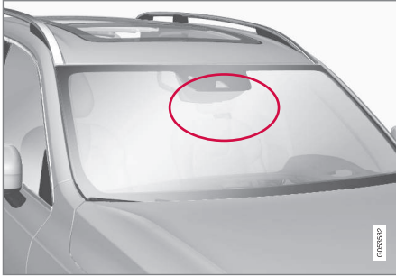
A kamera egység elhelyezkedése
