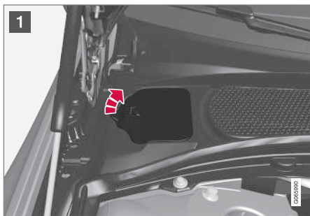
Vase d'expansion du système de refroidissement
