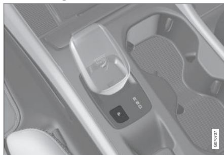
Übersicht über Wählhebel und Stellung P.
