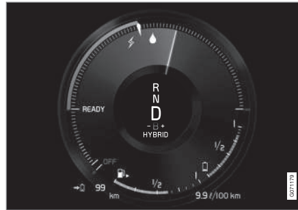
Fahrerdisplay bei Antrieb durch Elektro- und Verbrennungsmotor.
