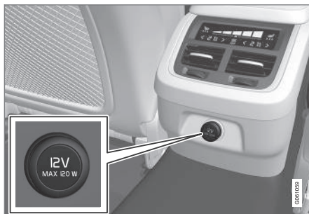
12-V-Steckdose in der Tunnelkonsole, Rücksitz.
