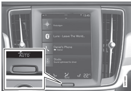
Home-Taste des Displays in der Mittelkonsole.
