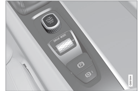
Startschalter auf der Tunnelkonsole.
