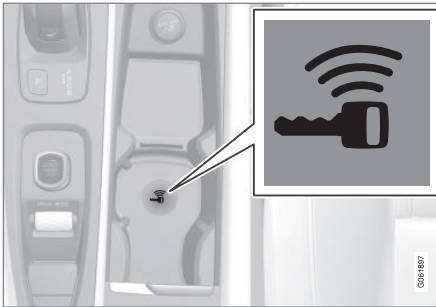
Lage des Schlüssellesegeräts in der Tunnelkonsole.
