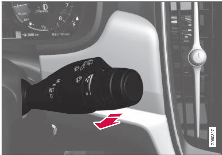
Waschfunktion, rechter Lenkradhebel.
