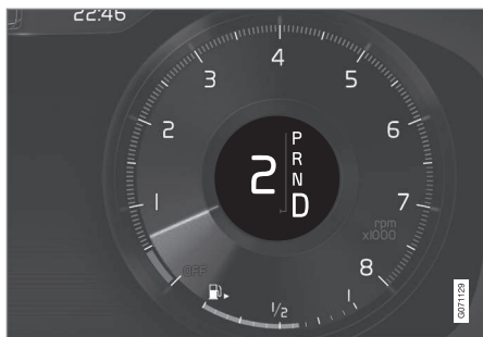
Førerdisplay ved girskift med ratthendler, stor girspak.
