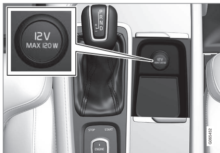
12 V strømuttak i tunnelkonsoll, forsete.
