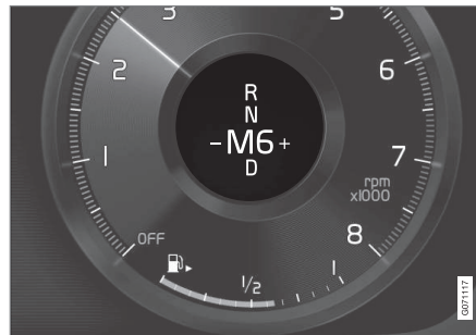
Girskiftindikator for liten girspak på 12-tommers førerdisplay*.
