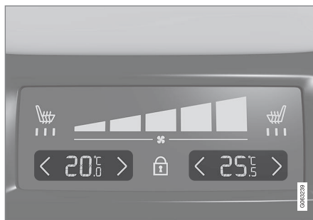
Commande de température sur le panneau de commandes climatiques arrière, sur la console de tunnel.
