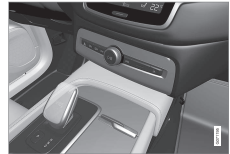
Vue d'ensemble du petit levier de vitesse pour lequel il n'est pas possible de désactiver le blocage de sélecteur de vitesses.
