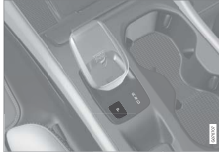
نظرة عامة على ذراع تغيير التروس ووضع الركن P بالنسبة لذراع تغيير التروس الصغير.
