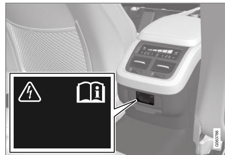
Elektrická zásuvka v tunelové konzole, zadní sedadlo.
