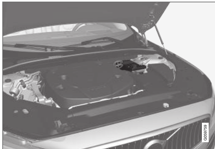
Podpůrná baterie se nachází v pouzdru u věže vzpěry.
