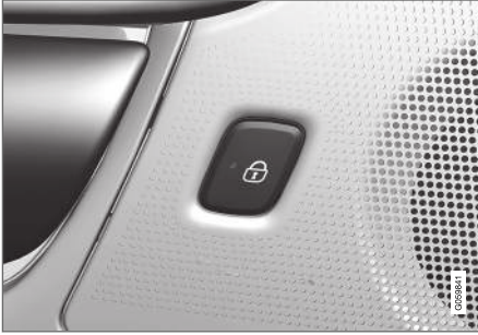
Arka kapıda gösterge lambalı kilit düğmesi.
