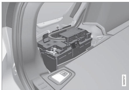
Startbatteriet är placerat i lastutrymmet.
