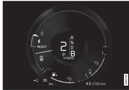
Bilen genererar ström till batteriet, batteriet laddas, t ex. vid lätt tryck på bromspedalen eller vid motorbromsning i utförsläge.
