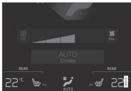
Knappar för eluppvärmda säten i gruppen Bakre klimat i klimattyn.
