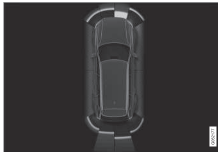
Bildskärmsvy med hinderzoner och sensorsektorer.
