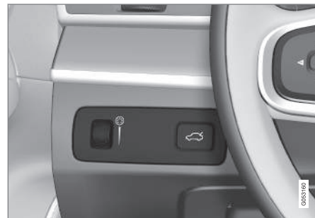
Tumhjul (till vänster) för att justera ljusstyrka.
