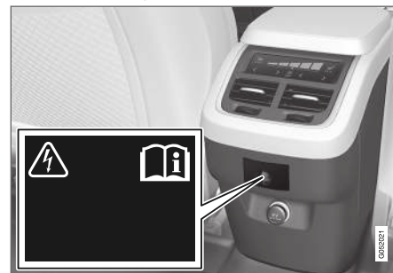
Strømuttak i tunnelkonsollen, andre seterad.
