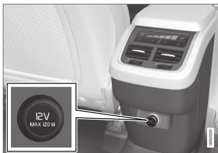
12 V-uttak i tunnelkonsoll, andre seterad.
