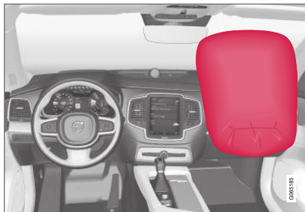
Kollisjonspute på passasjersiden i forsetet.
