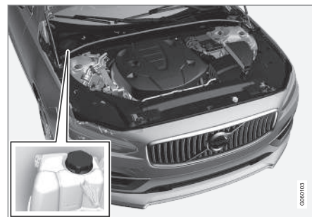
Ekspansjonsbeholder for kjølesystemet, bil med venstresjåfør.
