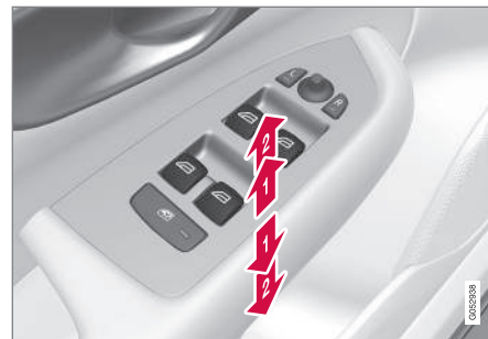
Regulering av vindusheiser.
