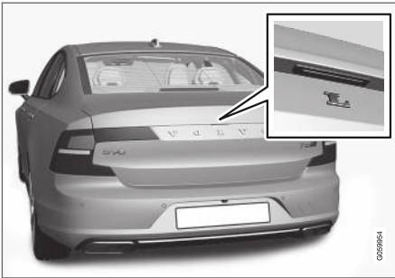
Gumuota paspaudimo plokštelė bagažinės dangčio rankenoje skirta tik atrakinti.
