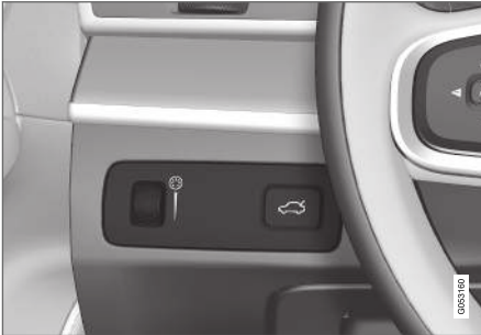
Forgókapcsoló (balra) a belső fényerő beállításához.
