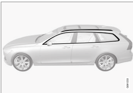
Alkatrészek, amelyek 3,5 és 11,5 pH-érték közötti tisztítószerrel moshatók.
