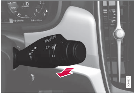
Fonction lave-glace, levier droit au volant
