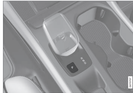
Vue d'ensemble du levier de rapport et position P
