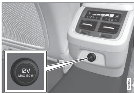
Prise électrique 12 V sur la console de tunnel, banquette arrière.
