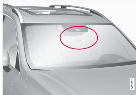
Emplacement de l'unité radar.
