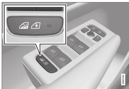
Botón de conexión y desconexión eléctrica.
