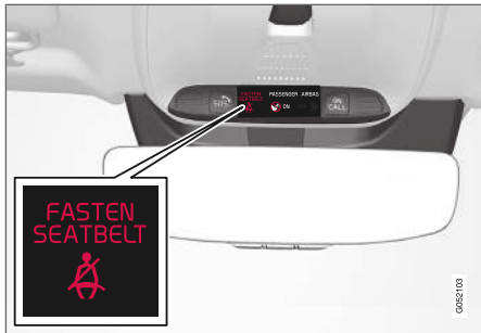
Aviso luminoso en la consola de techo.
