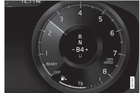
شاشة السائق عند تغيير التروس باستخدام محركات عجلة القيادة في وضع صندوق التروس اليدوي.
