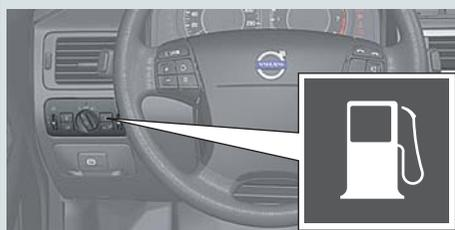
**Auf die Taste drücken, um die Kraftstofftankklappe zu öffnen.**
