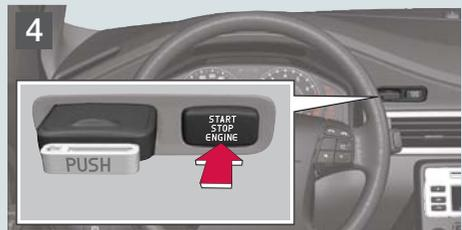
Auf die START/STOP/ENGINE-Taste drücken, um den Motor anzulassen.<sup>B</sup>
