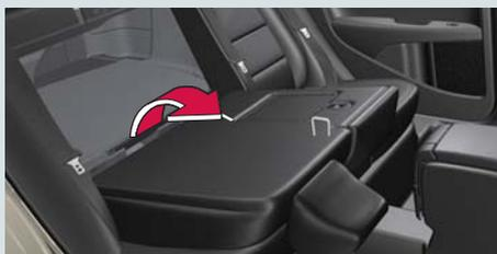
Sicherstellen, dass die hinteren Kopfstützen hochgeklappt sind. **Die Rückenlehnen umklappen.**
