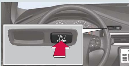
Auf die **START/STOP/ENGINE**-Taste drücken, um den Motor anzulassen.<sup>^</sup>
