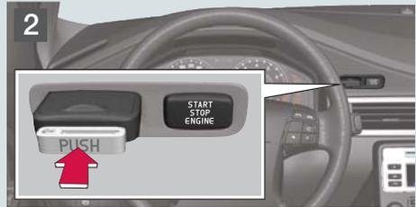
Leicht auf den Transponderschlüssel drücken. Dieser wird daraufhin eingezogen.
