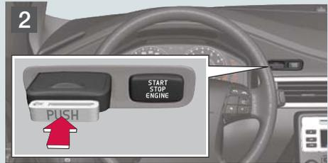
Leicht auf den Transponderschlüssel drücken. Dieser wird daraufhin ausgegeben. Das Automatikgetriebe muss sich in Stellung P befinden.
