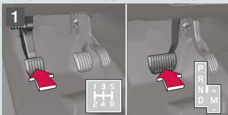
Mit dem PCC z. B. in der Hosentasche in das Fahrzeug einsteigen. **Das Kupplungs- oder Bremspedal durchdrücken.**
