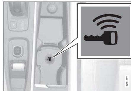
備用讀取器位於中央扶手控制台中。
