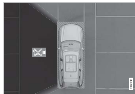
車輛左側攝影機故障。
