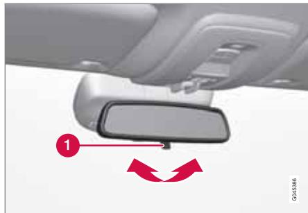
**1** Установка противоослепляющего положения
