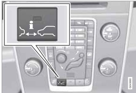
Чтобы включить или отключить функцию, нажмите кнопку в центральной консоли. Если в кнопке горит лампа – функция включена.
