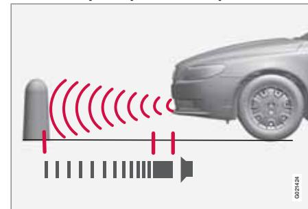
Расстояние, измеряемое по прямой перед автомобилем, составляет прим. 0,8 м. Звуковой сигнал, указывающий на препятствие перед автомобилем, поступает из одного из передних динамиков.
