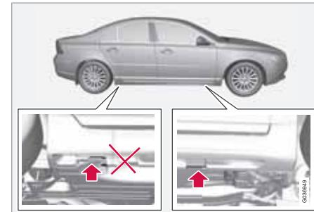
Если автомобиль поднимается с помощью стационарного подъемника, то подъемник следует устанавливать под передний край несущей рамы двигателя.
