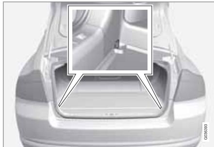
Откидные проушины для крепления груза<sup>1</sup> используются для фиксации стяжных лент, закрепляющих предметы в багажном отделении.
