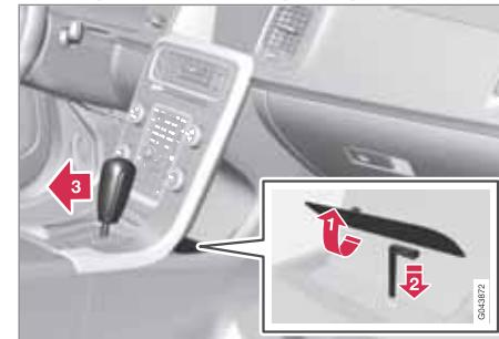
Если автомобиль находится в нерабочем состоянии, например, разряжена аккумуляторная батарея, то для перемещения автомобиля необходимо вывести рычаг переключения передач из положения **P**.
