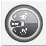
Вентилируемые передние сидения можно устанавливать только, если автомобиль оснащен ECC. Система вентиляции состоит из вентиляторов, встроенных в сидения, и спинок, затягивающих воздух через обивку сидений. Чем холоднее воздух в салоне, тем выше эффект охлаждения.
