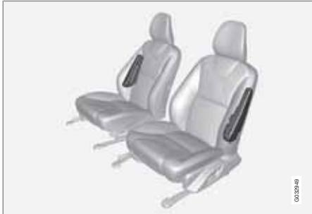
При боковом столкновении SIPS (Side Impact Protection System) направляет большую часть силы удара на балки, стойки, пол, крышу и другие элементы кузова автомобиля. Боковые подушки безопасности на стороне водителя и пассажира защищают грудь и бедра и являются важным элементом системы SIPS.
