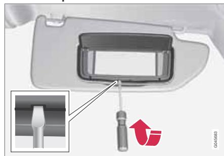
1. Вставьте отвертку в одну из двух прорезей и осторожно приподнимите блокировочный выступ на краю.
