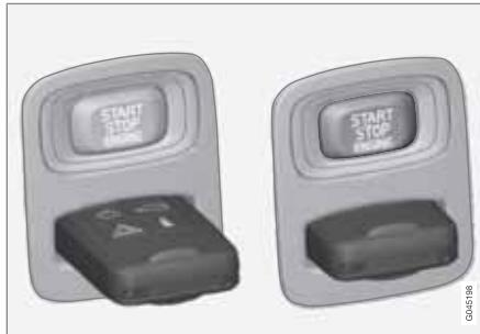
Замок запуска с выдвинутым/вставленным ключом зажигания.
