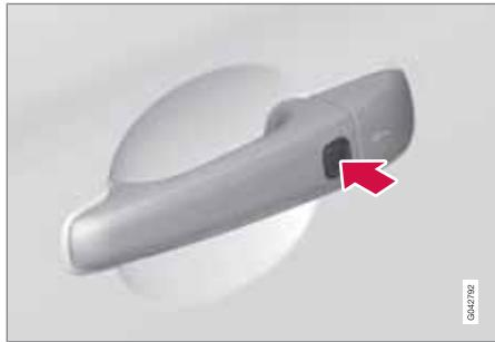
В автомобилях с системой Keyless во внешних дверных ручках имеется кнопка.
