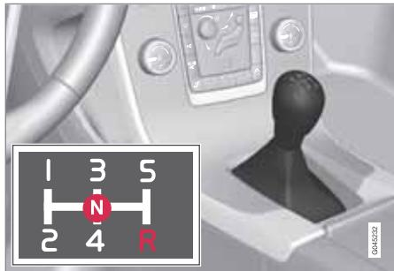
Схема переключения передач, 5-ступенчатая коробка передач.
