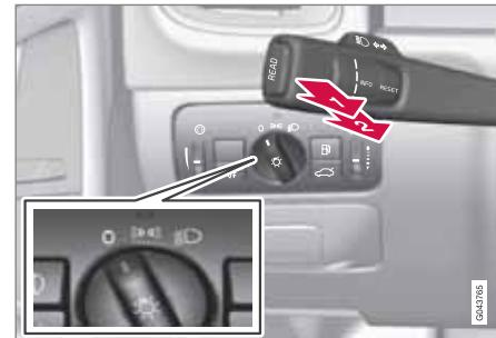
Ручка регулировки света и подрулевой рычаг.
