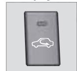
При включенной рециркуляции в клавише горит оранжевая лампа. Эта функция выбирается для прекращения доступа в салон плохого воздуха, выхлопных газов и пр. Воздух в салоне рециркулирует, т.е. если эта функция включена, воздух снаружи не поступает внутрь автомобиля.
