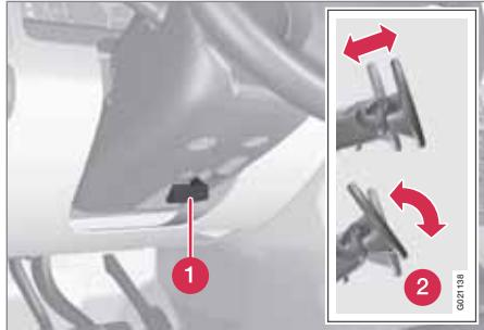
Регулировка рулевого колеса.
