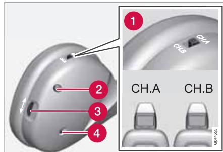
① Ручка управления для канала А (**CH.A**) или канала В (**CH.B**)
