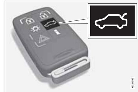
С помощью кнопки дистанционного ключа можно снять с сигнализации\*, отпирать и открыть только крышку багажника.
