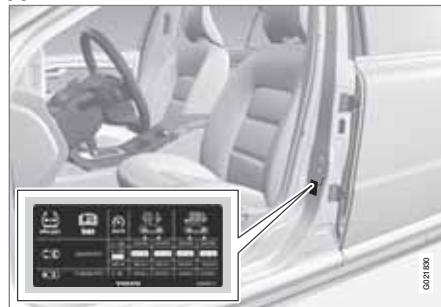
На наклейке, расположенной на дверной стойке со стороны водителя (между передней и задней дверью) указано давление в шинах при различной нагрузке и скоростях. Эта же информация приведена в таблице давления в шинах, см. стр. 404.
