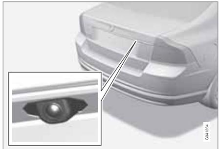
Камера установлена вблизи ручки открытия крышки.
