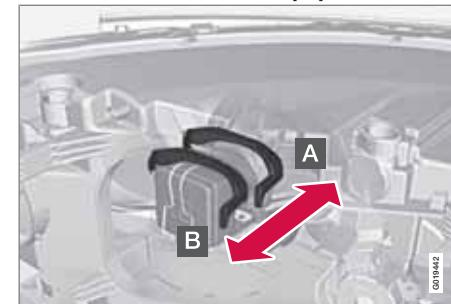
Регулировка формы светового пятна фар.
