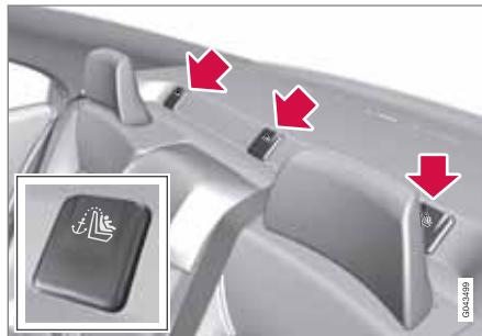
В автомобиле имеются верхние точки крепления детских кресел. Эти точки крепления расположены в полке для шляп и закрыты пластмассовыми крышками. Отогните вниз пластмассовые крышки, чтобы получить доступ к соответствующим точкам крепления.
