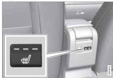
Одним нажатием на клавишу достигается максимальный обогрев – горят три лампы.
