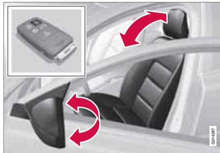
Когда автомобиль отпирается тем же дистанционным ключом, которым он запирался, и открывается дверь водителя, кресло водителя и внешние зеркала заднего вида автоматически устанавливаются в положения, хранящиеся в памяти ключа.
