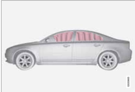
Надувной занавес IC (Inflatable Curtain) является составной частью SIPS и подушек безопасности. Он смонтирован в облицовке потолка вдоль боковых автомобилей и защищает пассажиров на внешних местах в автомобиле. При достаточно сильном столкновении датчики реагируют, и занавес надувается. Надувной занавес помогает во время столкновения защитить голову водителя и пассажиров от ударов о внутренние поверхности автомобиля.
