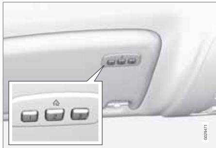
HomeLink® – это программируемый дистанционный пульт, с помощью которого можно управлять работой до трех различных устройств (например, ворота гаража, система охранной сигнализации, освещение внутри и снаружи помещения и т.п.), заменяя, таким образом, пульты дистанционного управления этих устройств. HomeLink® встроен в левый солнцезащитный козырек.
