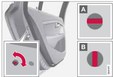
Регулятор замка для безопасности детей находится на задней кромке задних дверей, и доступ к нему возможен только при открытой двери.
