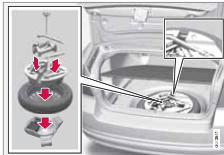
Под люком в полу грузового отсека находится буксировочная скоба, домкрат\* и баллонный ключ\*. Здесь также находится втулка для колесных гаек с "секреткой".
