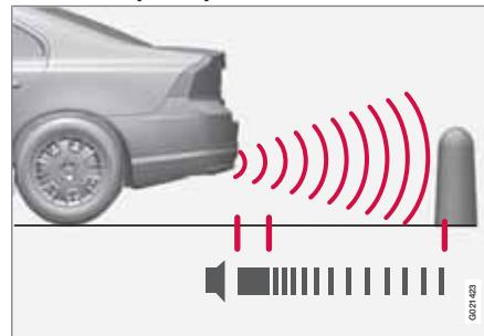
Расстояние, измеряемое по прямой сзади автомобиля, составляет прим. 1,5 м. Звуковой сигнал, указывающий на препятствие позади автомобиля, поступает из одного из задних динамиков.
