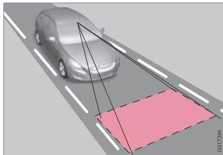
Функция предназначена для снижения риска т.н. одиночных аварий – аварий, которые происходят, когда автомобиль съезжает с полосы и может оказаться либо в кювете, либо на полосе встречного движения.
