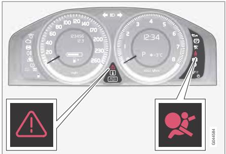
Предупреждающий символ в комбинированном приборе включается, когда дистанционный ключ находится в положении II или III. Этот символ гаснет примерно через 6 секунд, если система надувных подушек безопасности исправна.
