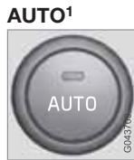
При помощи автофункции регулируется автоматически температура, кондиционирование воздуха, скорость вращения вентилятора, рециркуляция и распределение воздуха.
