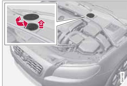
Бачок с жидкостью расположен на стороне водителя.
