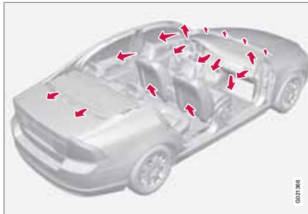
Поступающий воздух распределяется между различными соплами салона.
