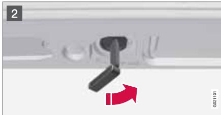
Крышку багажника можно открыть вручную с помощью плоского ключа, если аккумулятор автомобиля разряжен – в этом случае крышку невозможно открыть кнопкой на панели освещения.
