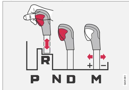
Рычаг можно свободно переводить вперед или назад между **N** и **D**. Остальные положения блокированы и управляются кнопкой блокировки на селекторе передач.
