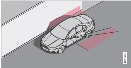
*Собственная тень, падающая на большую, светлую, ровную поверхность, например, шумоглушающий барьер или бетонные дорожные сооружения.*
