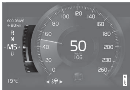
Indikace Eco na 8" displeji řidiče.
