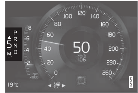
Indikace řazení na 8" displeji řidiče u velké řadicí páky.
