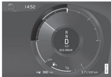
Indikace Eco na 12" displeji řidiče*.
