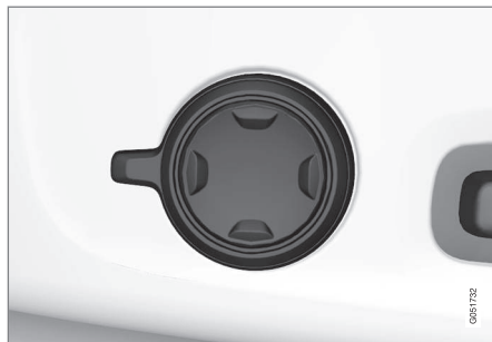
Multifunkční ovladač ve vozidlech s bederní opěrkou nastavitelnou ve čtyřech směrech*.
