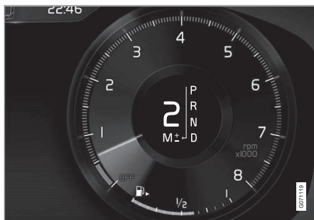
Displej řidiče při řazení pomocí pádel na volantu v režimu manuálního řazení, velká řadičí páka.
