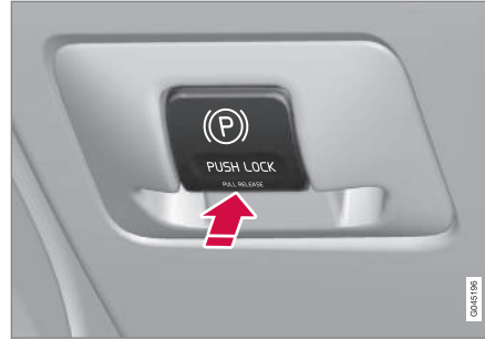
Stāvbremzes vadība - ieslēgšana.
