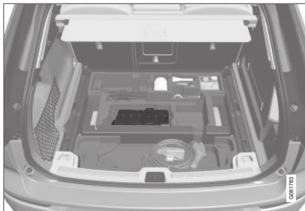
Starterio akumulatorius įrengtas bagažinėje.
