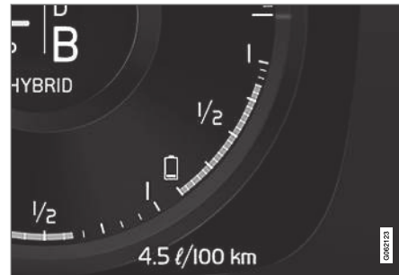
Automobilis generuoja srovę į akumuliatorių, akumuliatorius įkraunamas, pvz., švelniai spaudžiant stabdžių pedalą arba stabdant varikliu nuokalnėje.
