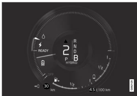
Automobilis generuoja srovę į akumuliatorių, akumuliatorius įkraunamas, pvz., švelniai spaudžiant stabdžių pedalą arba stabdant varikliu nuokalnėje.
