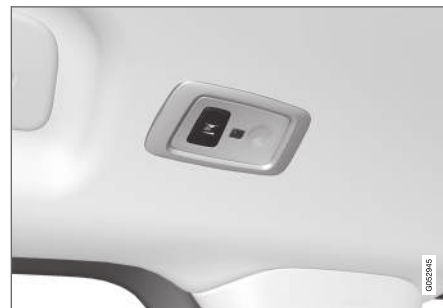
I bil med panoramatak* er det to lampeenheter, en på hver side av taket.
