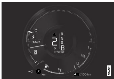
Førerdisplayet angir lading ved el-motorbremsing.
