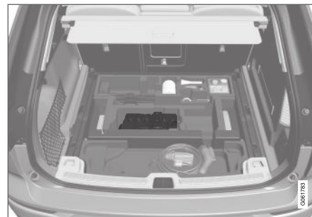
Startbatteriet sitter i bagasjerommet.
