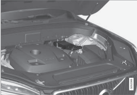
12 V atbalsta akumulators atrodas kastē blakus statnim.
