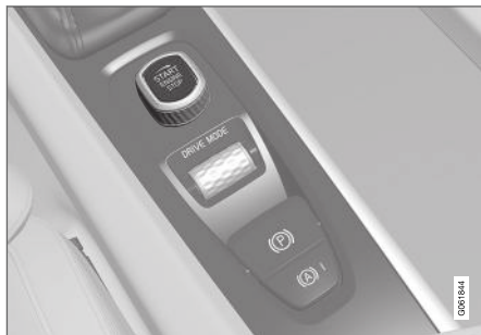
Startvredet i tunnelkonsolen.
