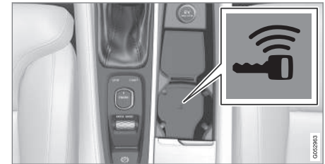
Varmistuslukijan sijainti tunnelikonso- lissa.
