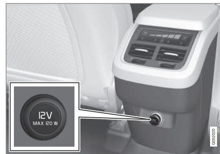
12 V:n sähköliitäntä tunnelikonsolissa, takaistuin.
