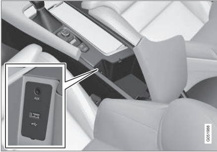
Port USB de la console de tunnel.
