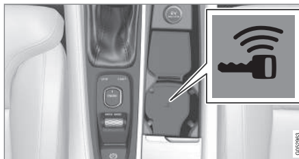
Lage des Schlüssellesegeräts in der Tunnelkonsole.
