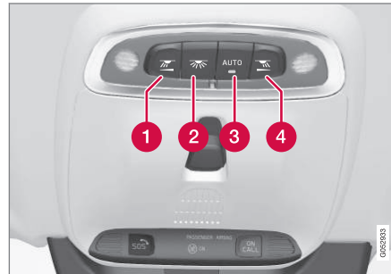
Bedienelemente in der Deckenkonsole für vordere Leseleuchten und Innenbeleuchtung.
