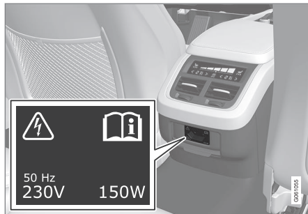
Steckdose in der Tunnelkonsole, Fond.
