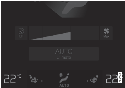
Temperaturtasten in der Klimaleiste.
