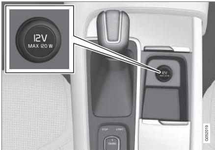
12-V-Steckdose in der Tunnelkonsole, vorn.
