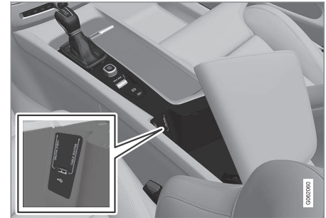
USB-Eingänge in der Tunnelkonsole.
