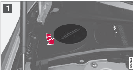
Ausgleichsbehälter der Kühlanlage, Linkslenker.
