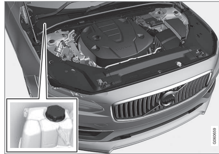
Ausgleichsbehälter der Kühlanlage, Rechtslenker.
