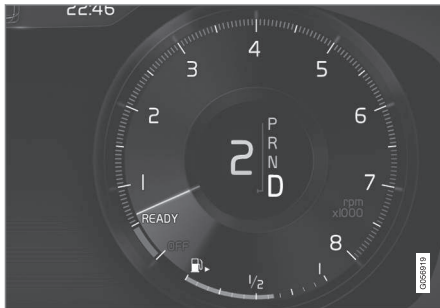
Fahrerdisplay beim Schalten mit den Schaltwippen.
