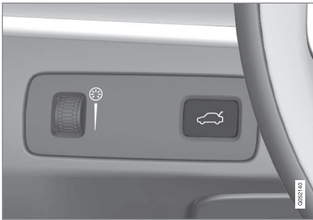
Taste zum Öffnen/Schließen auf dem Armaturenbrett.
