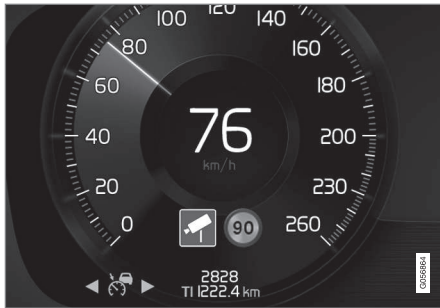
Radarkamera-Warnung auf dem Fahrerdisplay 81 .
