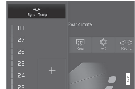
Synchronisierungstaste für den Temperaturregler der Fahrerseite.
