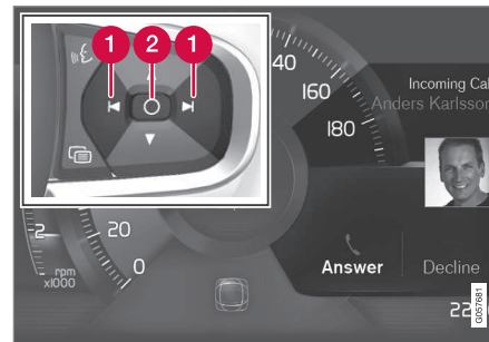
Meldung auf dem Fahrerdisplay 4 und rechtes Lenkradtastenfeld.
