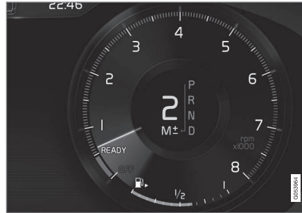
Manuelle Schaltstellung im Fahrerdisplay 2 .
