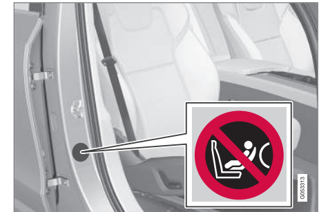
Aufkleber an der Türsäule auf Beifahrerseite. Der Aufkleber ist zu sehen, wenn die Beifahrertür geöffnet wird.
